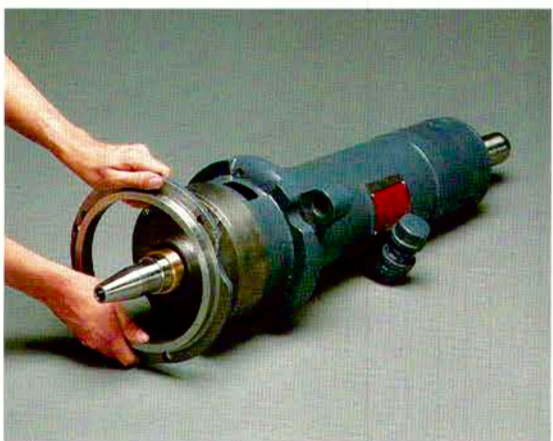
16. Coloque el Anillo Glándula sobre el Cilindro Corto.
