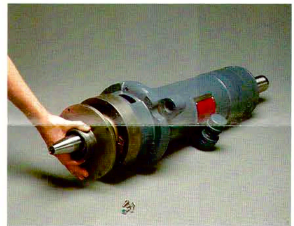
15. Fije la Cabeza del Cilindro Corto al Cilindro Corto usando los tornillos.
