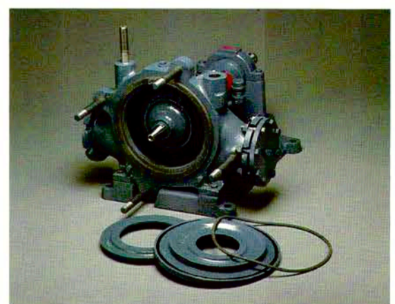
20. Instale el Anillo Protector del Cuerpo, Plato Seguidor y Empaque del Plato Seguidor en el barreno frontal de la Cámara de Entrada.
