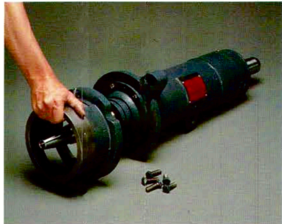
8. Fije el Cilindro Corto al Cilindro Largo. Nota: la muesca de la brida del Cilindro Corto debe estar en línea con la Conexión del Birlo de Ajuste en el Cilindro Largo.
