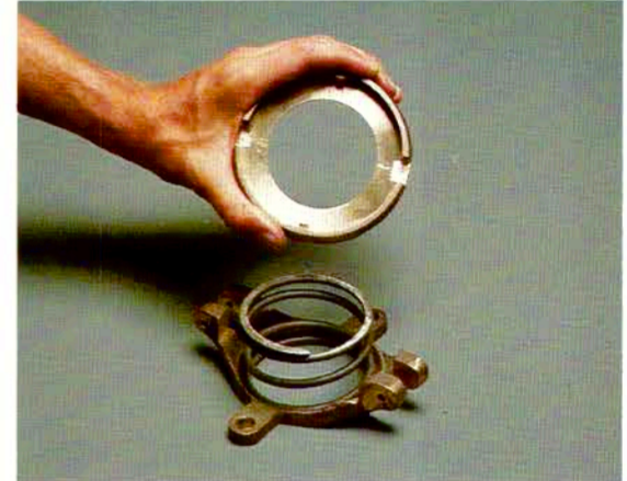
10. Coloque el Resorte de la Válvula de Retención en la Araña de la Válvula de Retención y cúbralo con la Placa del Diafragma de Empaquetadura de la Válvula de Retención.
