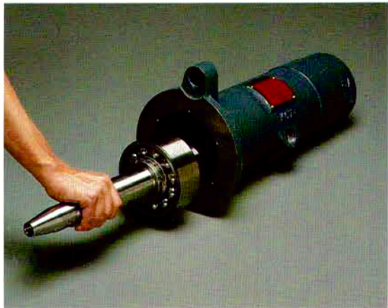
6. Instale la Flecha y el Ensamble de Cojinetes en el Cilindro Largo.
