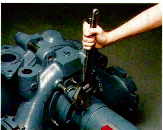
23. Ajuste la tolerancia del Impulsor. Para instrucciones específicas refiérase a la página 5 del Manual de Operaciones del Modelo K. Apriete la Tapa del Pedestal y las Tuercas de los Birlos del Anillo de la Glándula.
