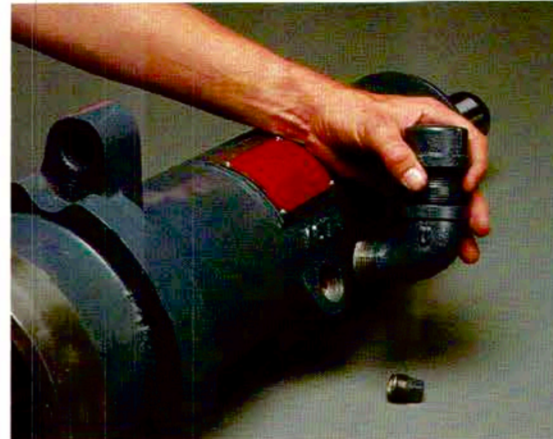
9. Instale el Ensamble del Codo del Depósito de Aceite y el Tapón de Drenaje de Aceite en el Cilindro Largo.
