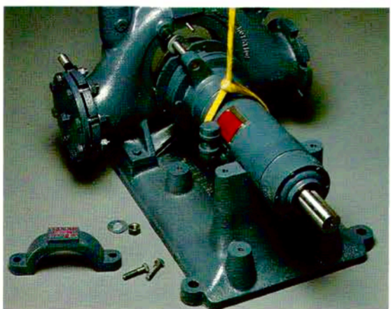
17. Instale la Unidad de los Cojinetes en el barreno posterior de la Cámara de Entrada. Coloque la Tapa del Pedestal y la Tuerca y Arandela del Perno de Empuje. No apriete todavía.
