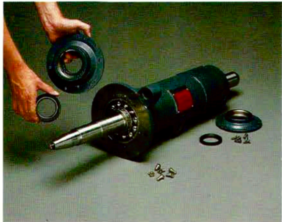
7. Coloque los Sellos de Aceite en las Tapas de los Cojinetes Frontal y Posterior y fíjelos al Cilindro Largo. Nota: el Sello de Aceite Frontal está diseñado para mantener las impurezas fuera de los cojinetes. Monte el Sello con el resorte hacia adelante.
