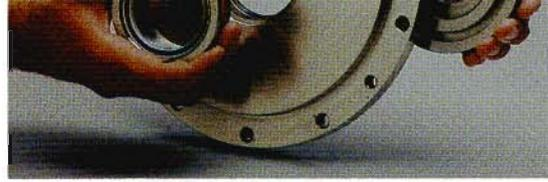
**11.** Passer l'obturateur tournant dans l'alésage du corps de soupape et le visser vers la droite dans la plaque de poussée.
