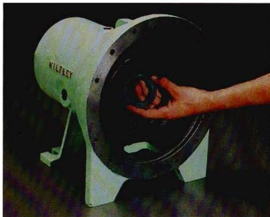
4. Installer le joint à lèvres avant, le ressort orienté vers l'arrière.
