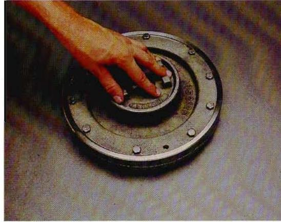
**16.** Fixer le siège de soupape avec les vis appropriées, et pousser sur l'ensemble pour vérifier le bon fonctionnement de la soupape d'étanchéité.
