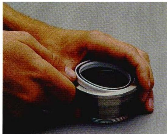
9A. Veiller à ne pas endommager la lèvre du joint d'étanchéité, et s'assurer que celui-ci repose bien dans son logement, sans distorsion.
