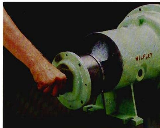
5. Installer soigneusement l'arbre d'entraînement dans le bâti.
