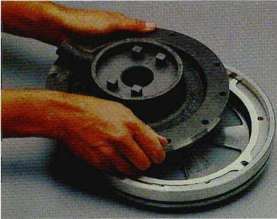
**15.** Introduire l'obturateur tournant et le corps de soupape dans la plaque de montage.
