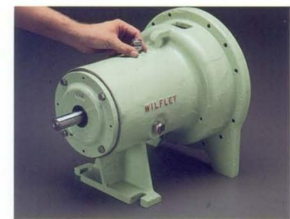
6. Instale el vidrio de nivel, el tapón de llenado y tapón de drenaje (no se muestra).
