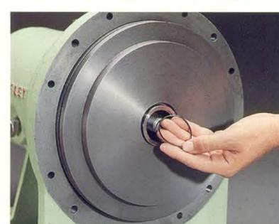
19. Deslice el ensamble de la placa de la carcasa completo sobre la flecha de la bomba y dentro de la cavidad del armazón e instale el aro sello del expulsor.
