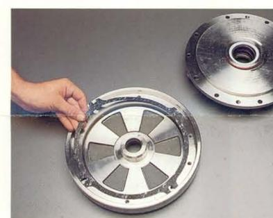
14. Coloque la empaquetadura de la placa de la carcasa en su posición dentro de la placa de la carcasa.
