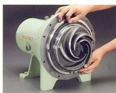
23. Ponga la empaquetadura de la carcasa en la placa de la carcasa.
