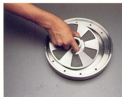
9. Coloque el expulsor (con los álabes hacia arriba) en la cavidad de la placa de la carcasa.
