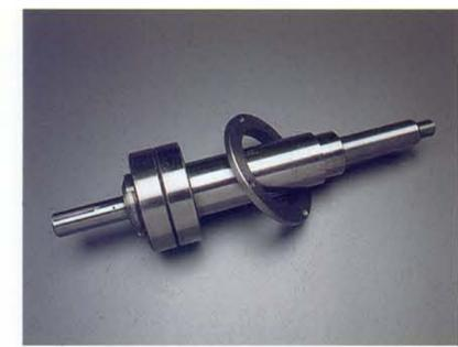
1. El anillo de fijación debe deslizarse en la flecha antes de instalar el cojinete delantero.
