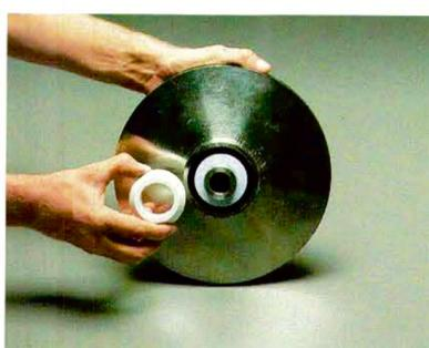
9. Deslice la argolla de sellado rotatoria y la empaquetadura en el cubo del impulsor.
