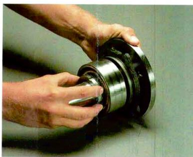
3. Coloque la tapa interior del cojinete de bolas posterior en la manga de impulsión, instale el cojinete de bolas y fíjelo en su posición.
