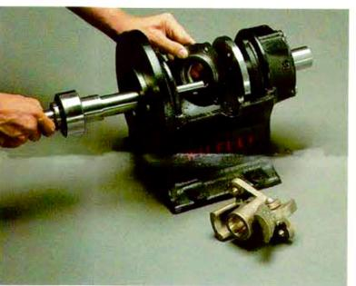
12. Instale el conjunto del eje pasándolo por el cuerpo, tapa interior del cojinete de bolas frontal, conjunto de la manga reguladora y la manga de impulsión.
