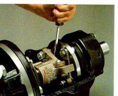
23. Mueva la manga reguladora hacia adelante, usando una palanca, varias veces para verificar que se mueva libremente y para acomodar la argolla de sellado fija.
