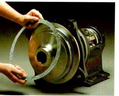
21. Coloque la empaquetadura de la placa de la carcasa en la placa de la carcasa.
