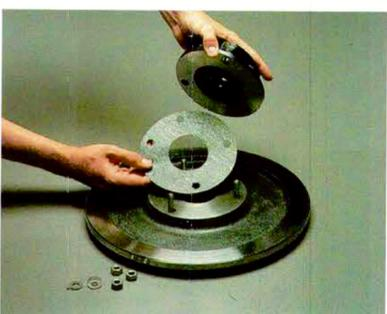
8. Coloque el alojamiento de la argolla de sellado fija y la empaquetadura en la argolla de laberinto de la placa de la carcasa e instale las tuercas y las arandelas. Apriete las tuercas con la mano.
