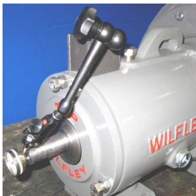
Figura 12: Método con indicador de carátula (método preferido)
