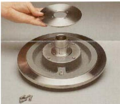
14. Coloque los balines (40A) en las ranuras del retén de balines (40). Para un funcionamiento correcto, los balines se deben colocar de forma simétrica. Observe el orificio pequeño en la cara del retén de balines. Este orificio se encaja sobre el pasador de resorte (34B) en el alojamiento del sello (34).
