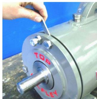
**Figura 15: Método con galga de espesores**
