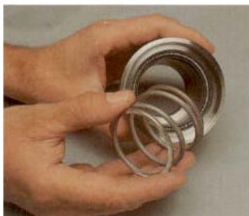
8. Deslice el alojamiento del sello rotatorio sobre la manga de la flecha (24). Empuje con cuidado la manga hasta que pase los anillos deslizantes y el sello de labio. El alojamiento del sello rotatorio debe encajar completamente sobre la manga de la flecha. Instale la junta tórica de la flecha (20) en la ranura de la manga de la flecha.
