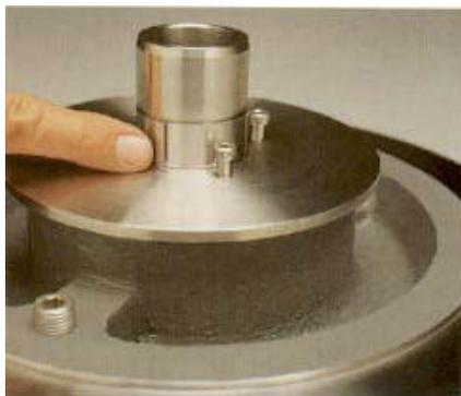
18. Coloque el alojamiento de balines sobre la manga de la flecha y asegúrelo con un anillo de retención (39A). Asegúrese de que los tornillos de ajuste estén asentados en los orificios del alojamiento de balines. Quizá deba empujar y comprimir el montaje del sello para encajar el anillo de retención en su ranura. La colocación de un bloque pequeño debajo de la manga de la flecha ayuda a comprimir completamente el montaje.
