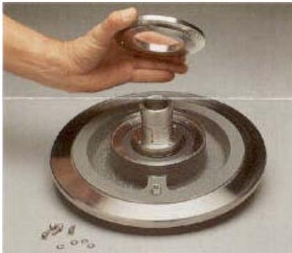
13. Monte el actuador (43) en la parte superior del alojamiento de sello rotatorio. Asegúrese de que los tornillos de ajuste (24C) y las tuercas (24D) estén bien ajustadas y utilice Loc-Tite® 261 o su equivalente para las roscas.
