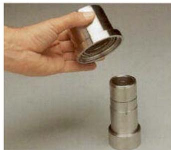
9. Inspeccione con cuidado el anillo de sello estacionario (23) antes de la instalación. La superficie interna del anillo de sello es la cara del sello estacionario y no debe tener rayones ni abolladuras. Instale el anillo de sello estacionario en el alojamiento de sello rotatorio. Asegúrese de no dañar el labio del sello. El labio del sello se debe asentar en el diámetro más amplio en el extremo del alojamiento.
